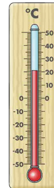
När det blir varmare runt termometern tar vätskan mer plats och stiger.
